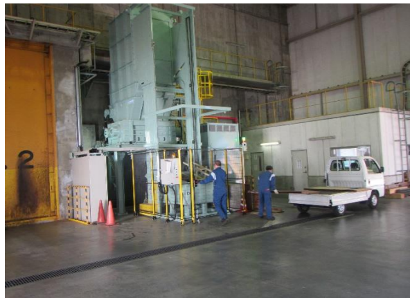
もくせい せい そだい 木製やプラスチック製の粗大ごみは ちよくとう はさいき とお ごみピット直投式の破砕機を通してごみピットへ
